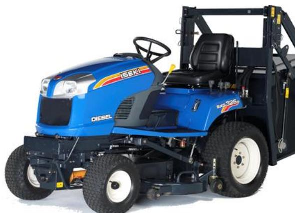
La tondeuse présente donc un très faible niveau de bruit et tond même l'herbe mouillée et haute. La SXG323 a une tondeuse avec une largeur de coupe de 122 cm et chez la SXG326 vous pouvez choisir entre une largeur de coupe de 122 cm ou 137 cm. Les deux modèles peuvent être équipés avec un bac de ramassage à vidange au sol ou jusqu'à une hauteur de 190 cm.
