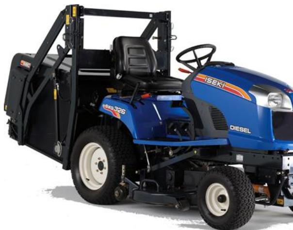
S'il n'est pas nécessaire de ramasser le bien coupé, le SXG326 peut être équipée d'un plateau de coupe mulching d'une largeur de travail de 137 cm.
